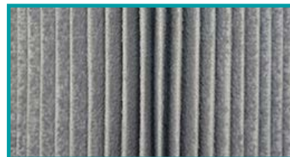
Cartucho filtrante después de la limpieza
